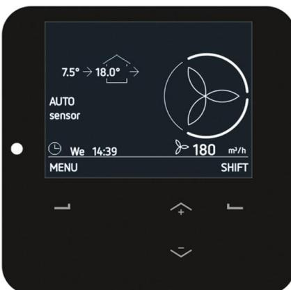
Das intuitive Display des Lüftungsgeräts Zehnder ComfoAir Q bietet eine Echtzeitanzeige zu allen relevanten Betriebsdaten und erhöht die Sensibilität des Nutzers bezüglich Energieverbrauch, Komfort und Umweltschutz. Das Gerät kann sowohl über den klassischen Dreistufenschalter als auch über eine App bedient werden und zeigt zudem einen anstehenden Filterwechsel an.
